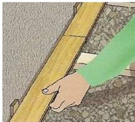
Assemblage à blanc d'une première rangée (tire-lame nécessaire pour le dernier morceau près du mur). Commencer avec le côté rainuré contre le mur.
