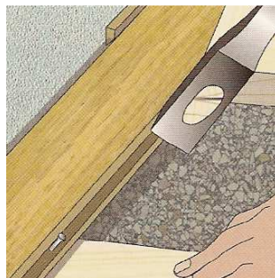
A chaque intersection avec une lambourde / gîte, le plancher est cloué de biais dans la languette.
